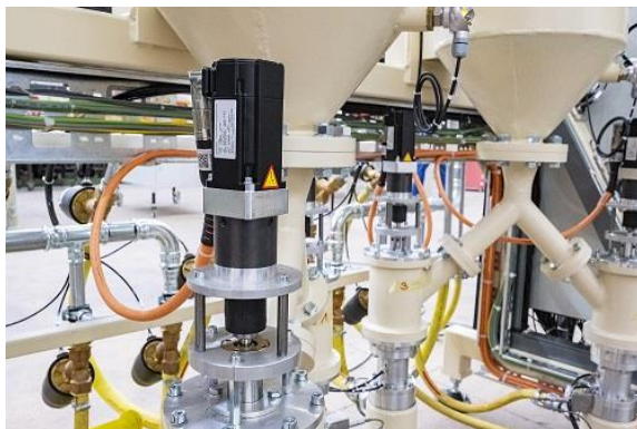
AKM-Servomotoren von KOLLMORGEN mit Einkabelanschlusstechnik in der Roxor(orShot peening)-Kugelstrahlanlage (links). Strahlmittel (Stahlkugeln) zur Oberflächenverdichtung (rechts).
