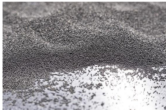
AKM-Servomotoren von KOLLMORGEN mit Einkabelanschlusstechnik in der Roxor(orShot peening)-Kugelstrahlanlage (links). Strahlmittel (Stahlkugeln) zur Oberflächenverdichtung (rechts).
